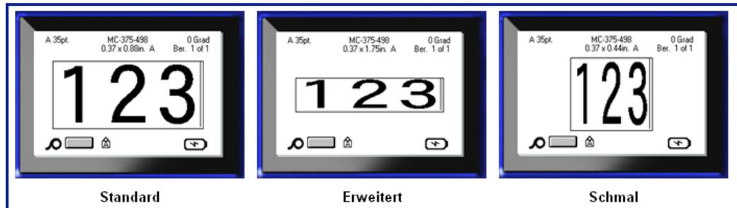
Abbildung 13 • Erweiterter und komprimierter Text
