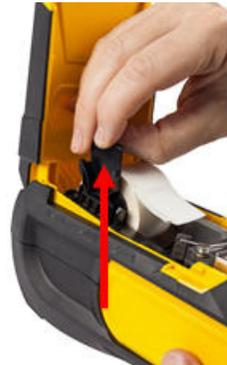
5. Wenn keine Medien mehr eingelegt werden sollen, die Druckerabdeckung schließen, indem Sie auf die Abdeckung drücken, bis sie einrastet.
