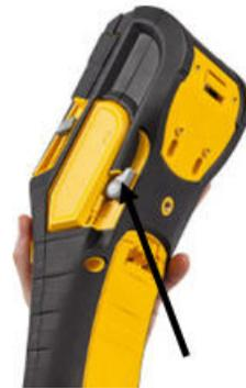
3. Wenn die Etikettenspule nicht leer ist, die Spule vorsichtig mit dem Finger aufwickeln, um die unbenutzten Medien rückwärts aus dem Druckkopf herauszuführen.
