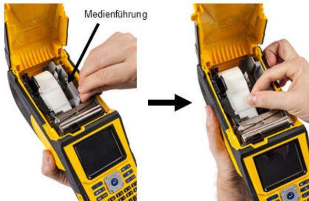
5. Bei eingeschaltetem Netzstrom die Vorschubtaste einmal drücken, um die Medien unter dem Druckkopf vorzuschieben.
