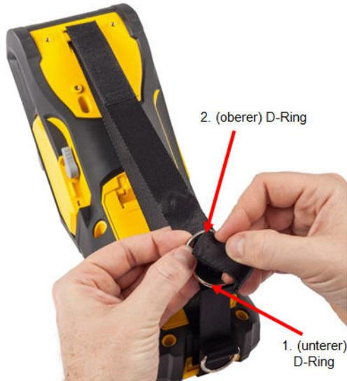
6. Am losen Ende des Gurtes ziehen, bis er sich fest gespannt anfühlt, und den Klettverschluss gegen den Gurt drücken, damit dieser flach liegt.
