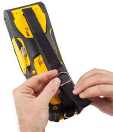
5. Das lose Ende des Gurtes zurück über den ersten (unteren) Ring und dann unter und durch den zweiten (oberen) Ring führen.
